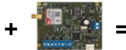
Комплект: Многофункциональная плата расширения GSM
